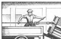
Figura 16 e 17 – Verificar se a altura de elevação descrita na placa de identificação é suficiente para levantar ou abaixar a carga. No caso da figura 16 a corrente foi insuficiente, na figura 17, a metragem da corrente houve sobra.
